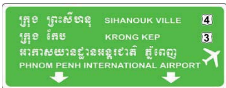
សញ្ញាបង្ហាញទិសដៅតាមគន្លងផ្លូវ (ដាក់លើរោងពិលីផ្លូវ) LANE DIRECTIONS SIGN TO CITIES, PROVINCES AND OTHER AREAS (ON A GANTRY)
